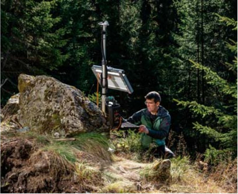
Dans la zone instable du couloir du Fregnoley, cinq GPS ont été installés. Les données sont consultables en permanence sur une plateforme par les professionnels.
