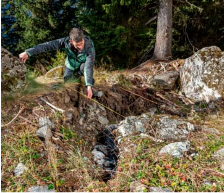
Les observateurs des dangers naturels effectuent parfois des mesures à la main pour suivre l'évolution de fissures dans le terrain.
