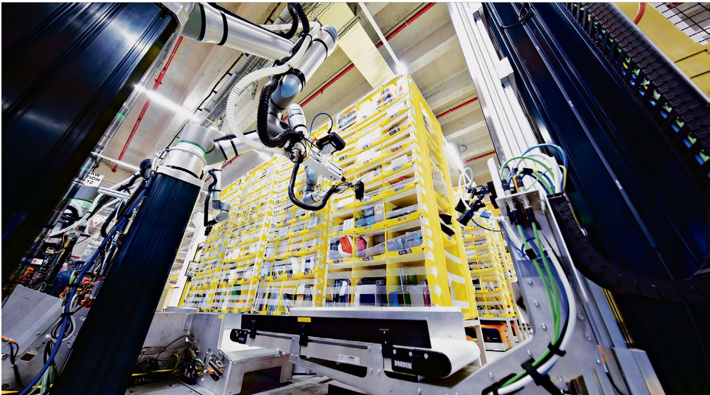
Présenté en mai, Vulcan est le premier robot d'Amazon à être doté d'un sens du toucher. Cette machine peut ranger délicatement les articles grâce à une préhension sensible à la pression, rendue possible par l'intelligence artificielle. (AMAZON)
